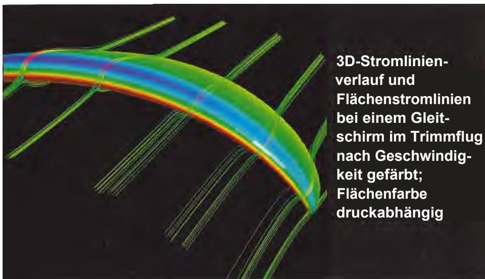
3D-Stromlinienverlauf und Flächenstromlinien bei einem Gleitschirm im Trimmflug nach Geschwindigkeit gefärbt; Flächenfarbe druckabhängig
