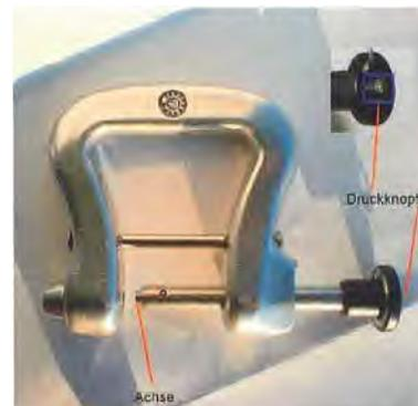
Ein Versagen der Pin Lock Karabiner während des Betriebs ist auf jeden Fall ausgeschlossen wenn die dem Karabiner beigegefügte Bedienungsanleitung beachtet wird: Prüfen Sie den ordnungsgemäßen Sitz des Kugelsperbolzens am Pin Lock durch Zugprobe am Griff ohne hierbei den Entriegelungsknopf zu drücken. Dieser Handgriff ist vor jedem Flug durchzuführen.
