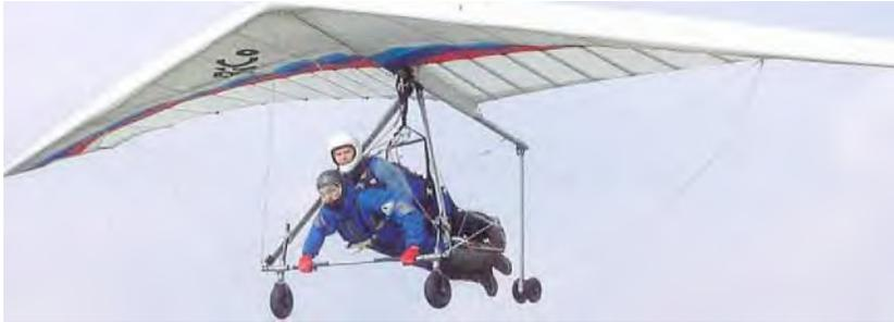
und die Geschwindigkeitssteuerung so leicht wie mit einem flotten Einzelsitzer. Doppelsitzig geflogen war eine Tunnelvergrößerung kaum feststellbar. Die Steuerung als Tandem blieb leichtgängig und erforderte geringere Ausschläge als solo geflogen. Den Sink- und Gleitleistungsvergleich Pico gegen BiCo hat Walter noch einmal versucht: Im Leerlauf ist er chancenlos.
