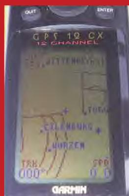
31 Foto des Mapdisplay eines Garmin 12 CX mit Lufträumen C Leipzig, CTR Leipzig, CTR Holzdorf und ED-R70 als Vorbereitung für einen Flug vom Flugplatz Torgau-Beilrode nach Nordwesten.
