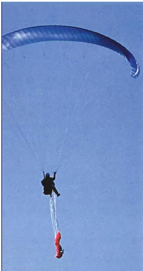
*Das Startgewicht des Piloten sollte mindestens 25 % niedriger liegen, als die Anhängelast, bei welchem das Rettungsgerät die maximal zulässige Sinkgeschwindigkeit von 6,8 m/Sek. aufweist.*
