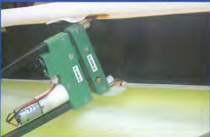
Das Rippenservo: Mit diesen Aktoren kann der lokale Anstellwinkel der Rippen sehr schnell und exakt im Flug in beliebiger Konstellation, verändert werden. Dadurch ist es möglich, im schnellen Gleitflug die verlustbringende Schrägung zu minimieren. Im Langsam- und Kurvenflug sorgen diese Aktoren für die „lebensnotwendige“ sichere Schrägung, die dann einen einseitigen Strömungsabriss nahezu unmöglich macht. Auch als „Querruder“ während schneller Gleitphasen erwies sich die einseitige Überhöhung der Schrägung als effektive Steuerhilfe. Mit nur 450 Gramm Gewicht und 3000 N (300 kg) Stellkraft sind sie die leichtesten Aktoren. Aus Gesamtgewichts- und aus Nutzen/Aufwand-Gründen sind sie bei den beschriebenen Autopilotfunktionen nicht beteiligt.
