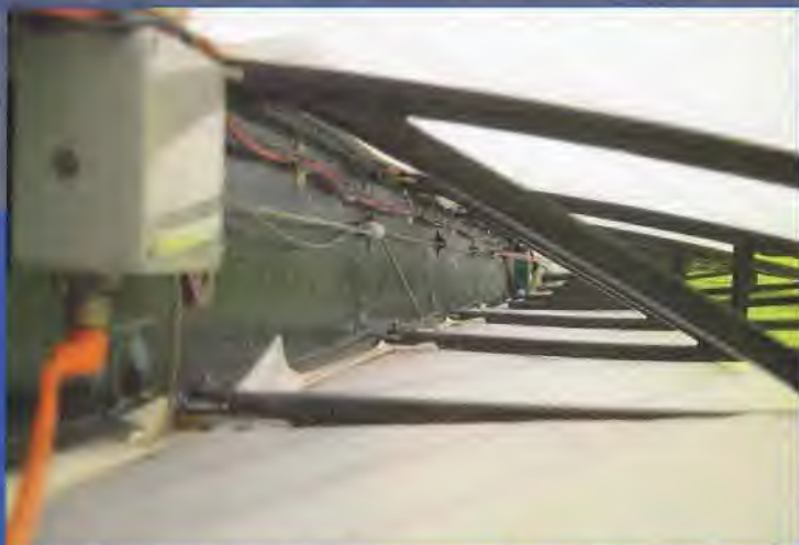
Die Spoilerservos: Sie sind an die bestehende Seilzugverbindung zu den Spoilern gekoppelt und ermöglichen bei hoher Stellgeschwindigkeit t \leq 1 s, 200 N (20 kg) Stellkraft und 500 Gramm Gewicht außer der normalen Rechts-, Links-Steuerung auch die kollektive (gemeinsame, gleichsinnige) Steuerung beider Lenkspoiler. Dadurch können die Funktionen „Höhenruder“, Störklappe (Butterfly) und teilweise Rückstromtasche realisiert werden.
