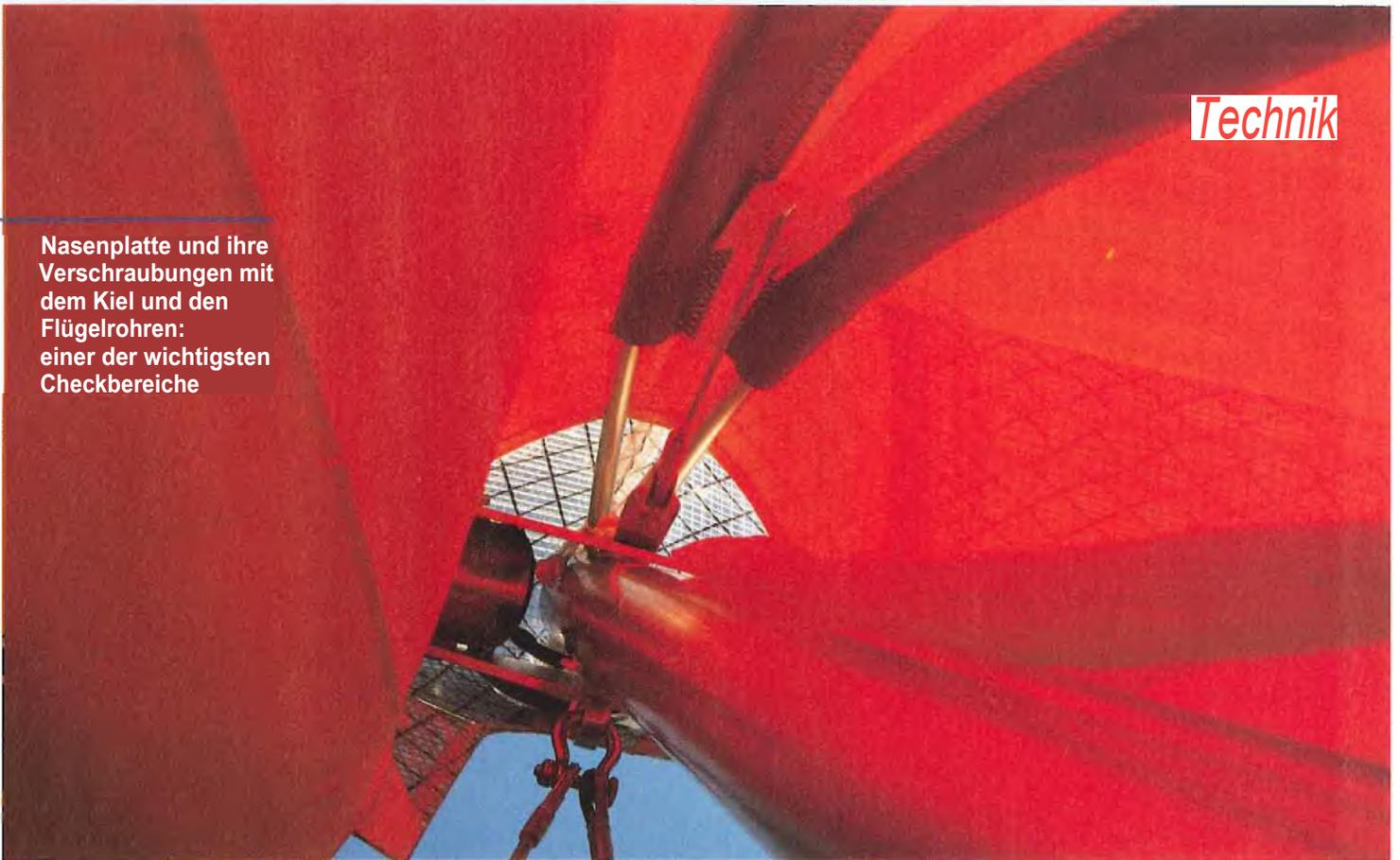
Der D-Holm kann durch eine optische Kontrolle, beziehungsweise Abfahren oder Abtasten mit der Hand nachgeprüft werden. Zu beachten ist besonders die Funktion der Steuerung, ihr kompletter Mechanismus einschließlich der Steuerseile und Umlenkrollen sowie die Anlenkung der Spoiler. Funktioniert sie nicht leichtgängig, ist das ein Indikator für eine eventuelle Beschädigung oder einen Aufbaufehler. Ob ein Schaden
