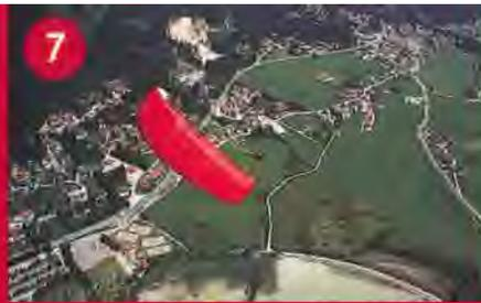
**4,5 Sekunden nach dem Einklappen** Der Einklapper hat sich wieder geöffnet. Der Pilot stabilisiert die Kappe durch beidseitiges Anbremsen.
