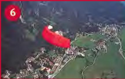
**4 Sekunden nach dem Einklappen** Die Kappe ist nun voll "auf der Nase", mit einem Nickwinkel von ca. 60 ° Grad. Der Schirm hat von Beginn des Einklappens inzwischen etwa 160 ° Grad weggedreht. Drehgeschwindigkeit, Höhenverlust und Fliehkraft sind jetzt am größten. Der Einklapper beginnt sich nun zu öffnen.
