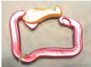
Alle Karabiner besitzen die gleiche Bruchlage. Der Rissausgang liegt im Radius des langen Schenkels
