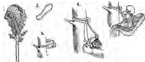
herabfallen. (2) Rettungsschlinge, Nutzlänge ca 1,5 m lang, Festigkeit ca 3000 Kp. (3) Ein Ende der Schlinge wird um den Baum geschlungen und durch das andere Ende geführt. (4) Schlingenende in einen bzw. beide Gurtzeugkarabiner einhängen. (5) Unter Spannung zieht sich die Schlinge um den Baum/Ast fest, der Pilot ist gesichert und kann in Ruhe auf Hilfe warten.
