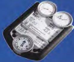
Eine optimierte Benutzerführung ist die Basis dieses Entwurfes von Michael Schubert, bei dem ein Drehschalter eine intuitive Gerätebedienung ermöglicht. Separate Displays gestalten den Informationsablauf übersichtlich. Alle Einstellungen werden vor dem Flug vorgenommen, so dass während des Fluges das Gerät nicht bedient werden muss.
