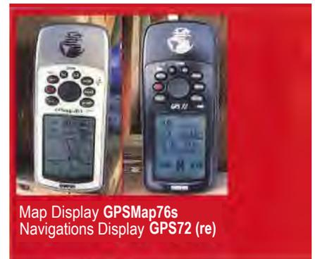
In Vergleich zählten beide, der GPS72 und der GPSMap76s, zu den langsamsten bei der Initialisierung und zu denen, die beim schwachen Satellitenempfang am frühesten aussteigen. Grund dafür könnte die Antenne sein – laut Garmin funktioniert die „Quad Helix“ Antenne am besten beim senkrechten Betrieb. Unser Test-Setup hatte beide Geräte flach liegend, wie es im Flugbetrieb am bequemsten ist.
