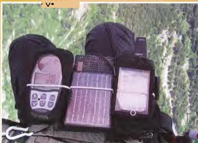
Cockpit: Vario, Solarzelle, GPS
