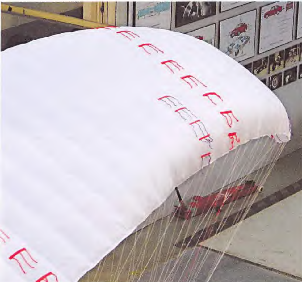
Wollfäden zur Visualisierung von Strömungsablösungen
