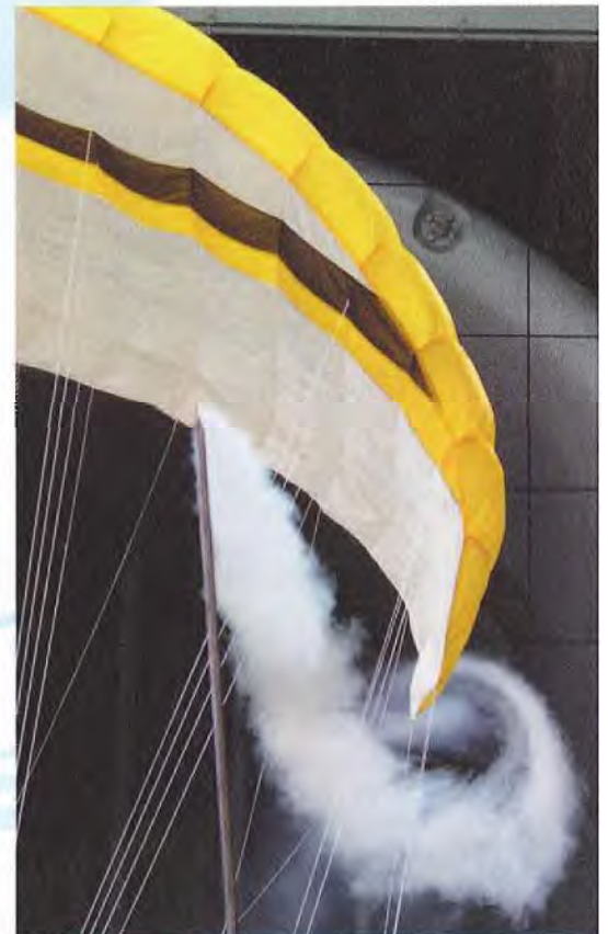
Oben: induzierter Randwirbel, Aussenansicht
