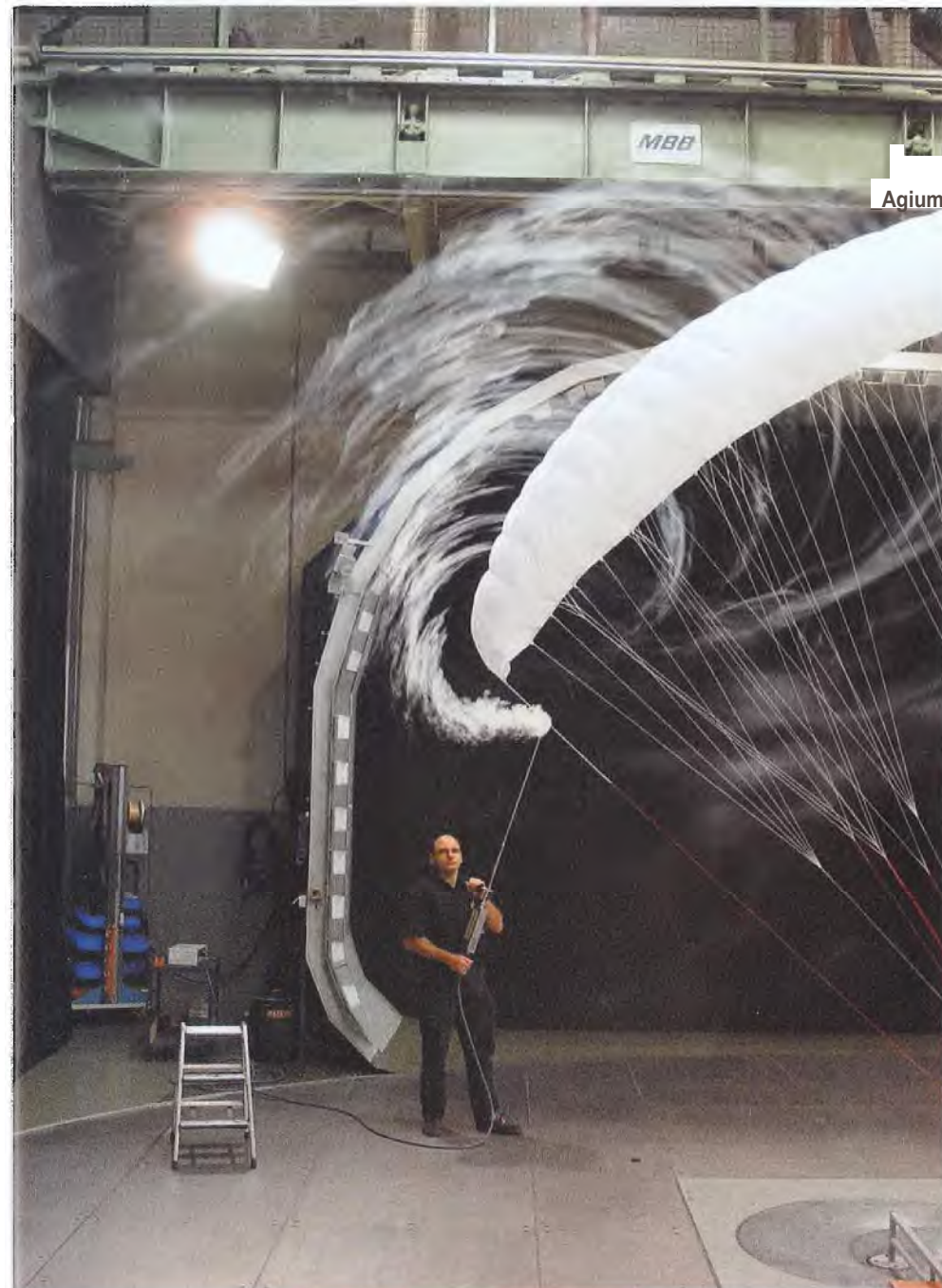
Wirbelbildung am Flügelende, Innenansicht des Wirbeis
