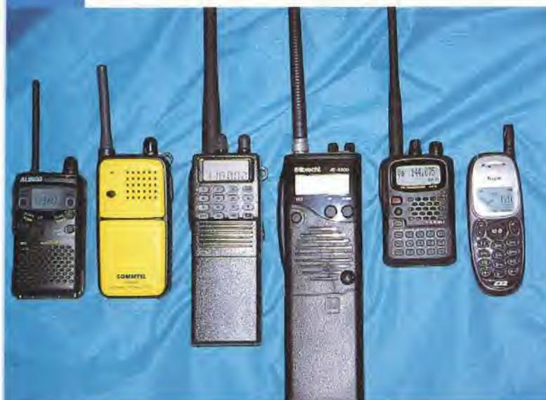
Sechs Funkgerätetypen für Gleitschirm- und Drachenflieger. Von links: 20-Kanal LPD-Gerät, gelbes 1-Kanal LPD Billigergerät, Flugfunkgerät, CB-Hobbyfunk-Gerät, Neuestes 2m/70cm Dualband Gerät, WAP-Handy
