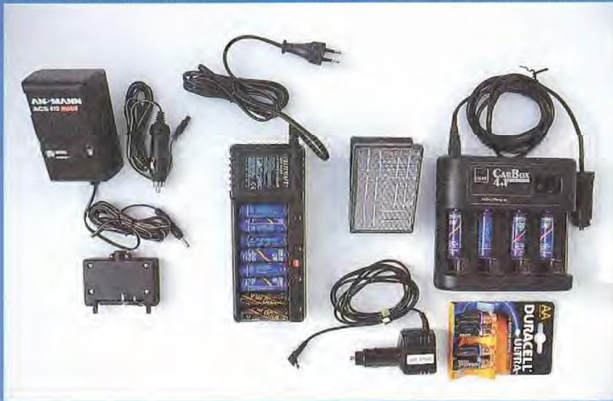
Von 35 Mark bis /60 Mark. Ladeeinrichtungen von links: Optimales Asmann Kombiladegerät für 220 und 12 Volt, 220 V Standard-Ladegerät mit Entladeeinrichtung gegen den Memory-Effekt, pfiffig: Solar-Ladegerät aber ohne Entladeeinrichtung, leistungsschwach: 12 V Stecker-Ladegerät, universelles 12 V Ladegerät für alle Batterietypen, Alkali-Batterien für Fernreisen
