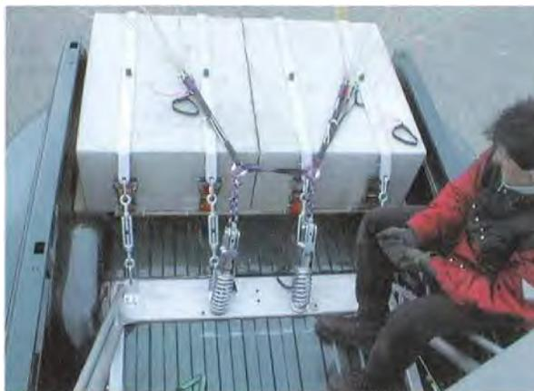
Der Abwurf des Gleitsegels erfolgt über modifizierte Bombenklinten und ist mit einer Handbewegung möglich
