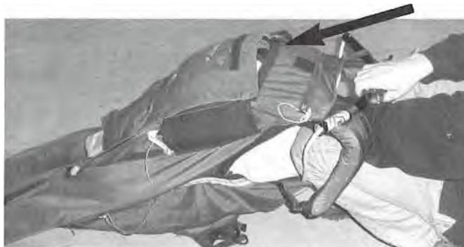
ert schlagartig den Anstellwinkel. Deshalb stürzte der Hängegleiter in niedriger Flughöhe unkontrolliert in einem sehr steilen Winkel ab. Theoretisch könnte sich der Hängegleiter in größerer Höhe nach vorne überschlagen.
