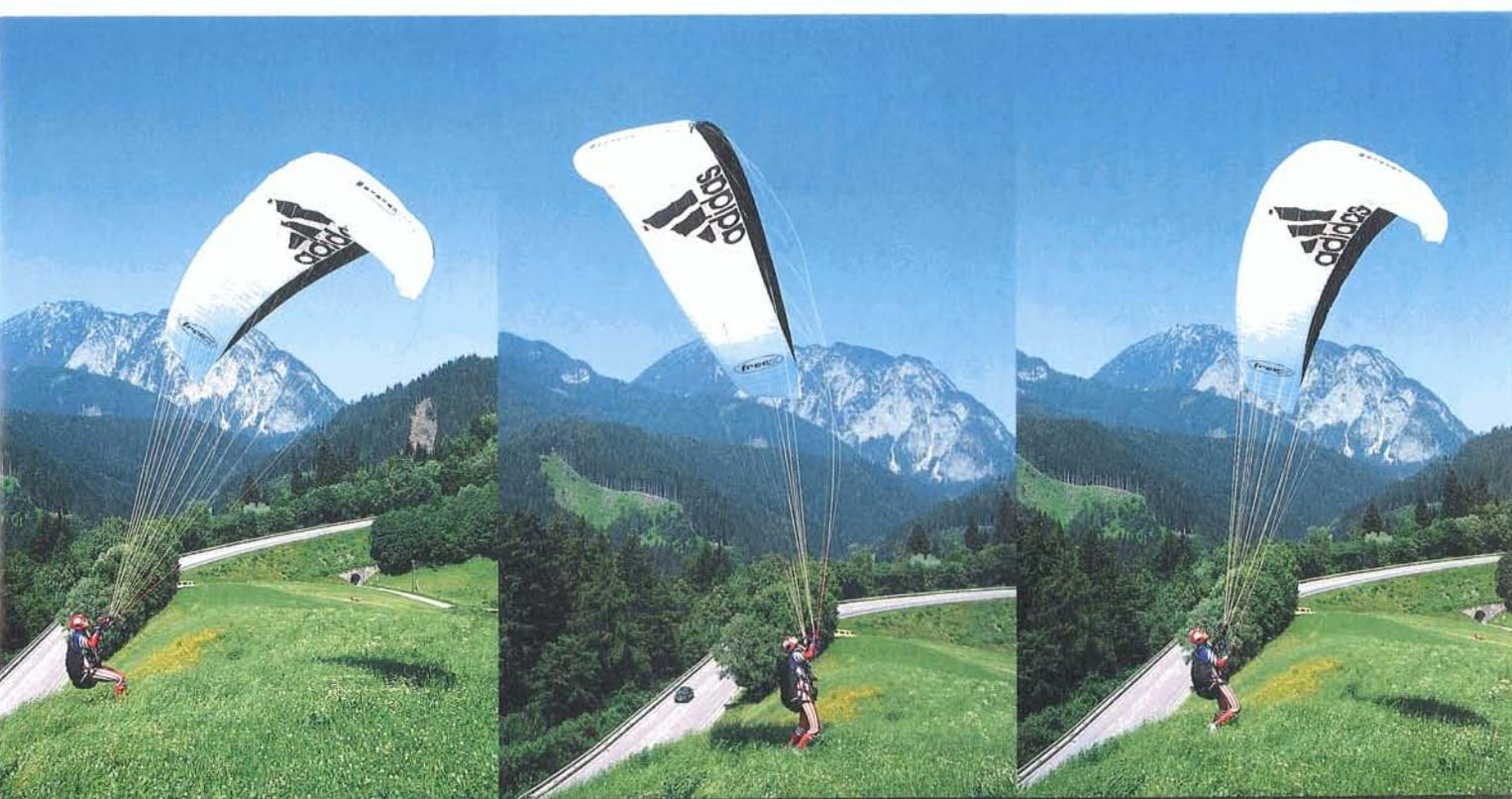
Durch volles Lösen der Bremsen schießt das Gerät vorne über
