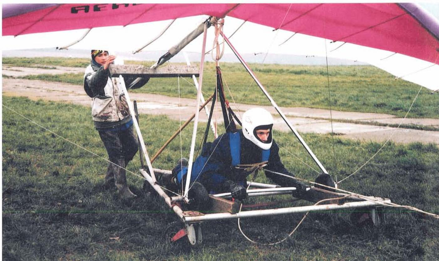
Immer mehr Schleppiloten benutzen als Starthilfe eine Art Hilfsfahrwerk, das nach dem Abheben am Boden bleibt und den Fußstart gänzlich ersetzt. Beim Doppelsitzerstart mit Hängegleitern ist diese Startmethode die sicherste Art, Pilot und Passagier bei Nullwind, ja sogar bei leichtem Rückenwind zu starten. Sollen Passagierflüge an der Winde oder mittels UL-Schleppstart erfolgen, ist der Rollstart sogar vorgeschrieben,
