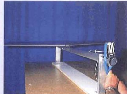
**Aufhängung unter Last - Flosse aerodynamisch neutral auf dem Kielrohr aufliegend**
