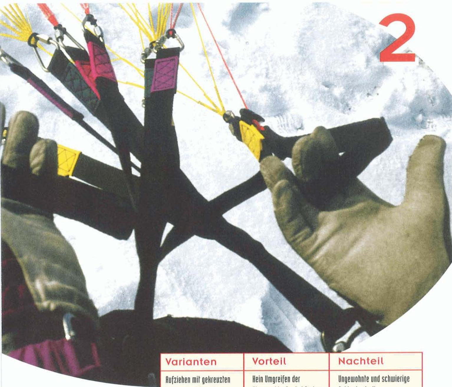
um): Ring- und kleiner Finger der linken Hand halten die Schlaufe der rechten Steuerleine möglichst weit außen links an der Griffversteifung. Hierbei ist zu beachten, daß man auf die Handinnenfläche schaut. Bei der rechten Hand sind es Zeige- und Mittelfinger, die auf der Versteifung der linken Steuerleinschlaufe möglichst weit links greifen. Auch hier blickt man auf die Innenfläche der Hand.
