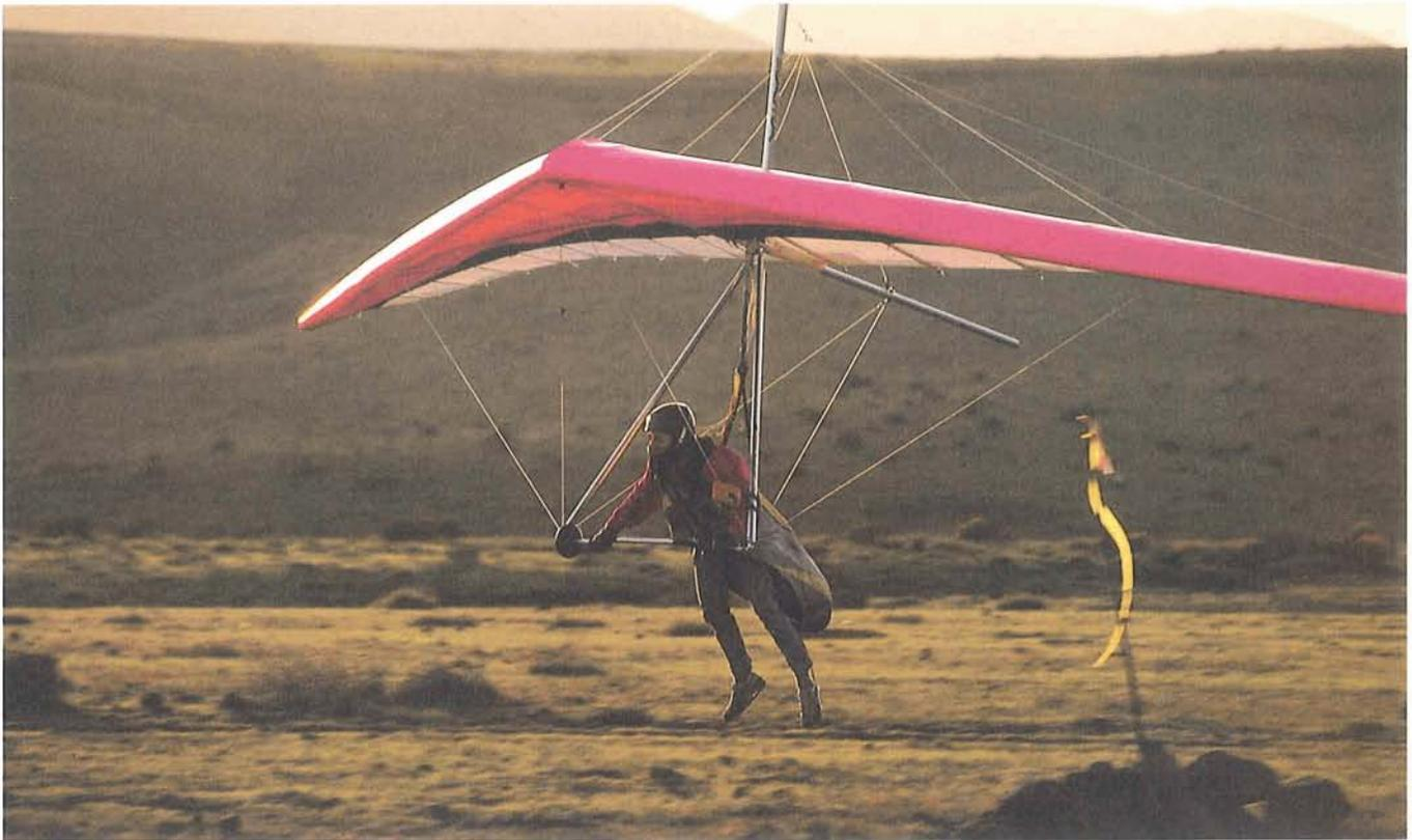
chen. Ist die Armlänge für die Druckpunktrücklage zu gering, so entsteht ein Geschwindigkeitsbereich, der nicht stationär erfliegbar ist. Der Pilot muß nun vor Erreichen dieses Geschwindigkeitsbereichs den Drachen so kräftig ausstoßen, daß die Strömung plötzlich und gleichzeitig am gesamten Flügel abreißt und der aufgebaute Widerstand die Restenergie verzehrt. Vorsicht: Auf halbherziges Ausstoßen reißt die Strömung nicht ab und das Gerät setzt die Fahrt in Höhe um.
