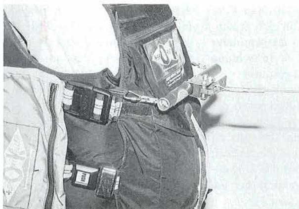
**Die Klinken muß sich in jeder Situation auslösen lassen. Bei Selriss darf sie den Piloten nicht verletzen können.**
