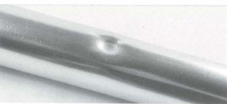
Die Schlagversuche im Labor hinterlassen am Aluminiumrohr deutliche Dellen. Das Carbonrohr zeigt bei gleicher Schlagbelastung äußerlich keine Schäden.
