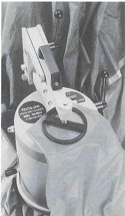
Neue Technik: Textiluhr prüft Gleitsegel-Tücher auf Luftdurchlässigkeit
