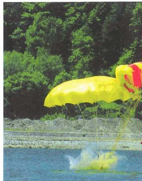
Kann der Pilot dagegen die Hauptkappe zu sich hineinziehen, so steht einem geraden Abstieg am Notschirm und einem erträglichen Aufprall nichts mehr im Wege.
