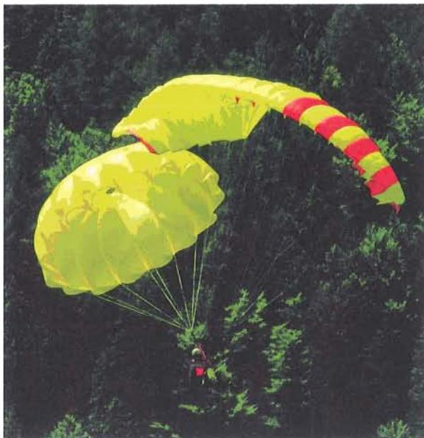
Sobald die Reserve offen ist, sollte der Pilot Einfluß auf den Hauptschirm nehmen. Ist er noch flugfähig, so wird er durch eine Scherenstellung zwischen Rettungsschirm und sich die Sinkgeschwindigkeit stark erhöhen und für Pendelbewegung sorgen.
