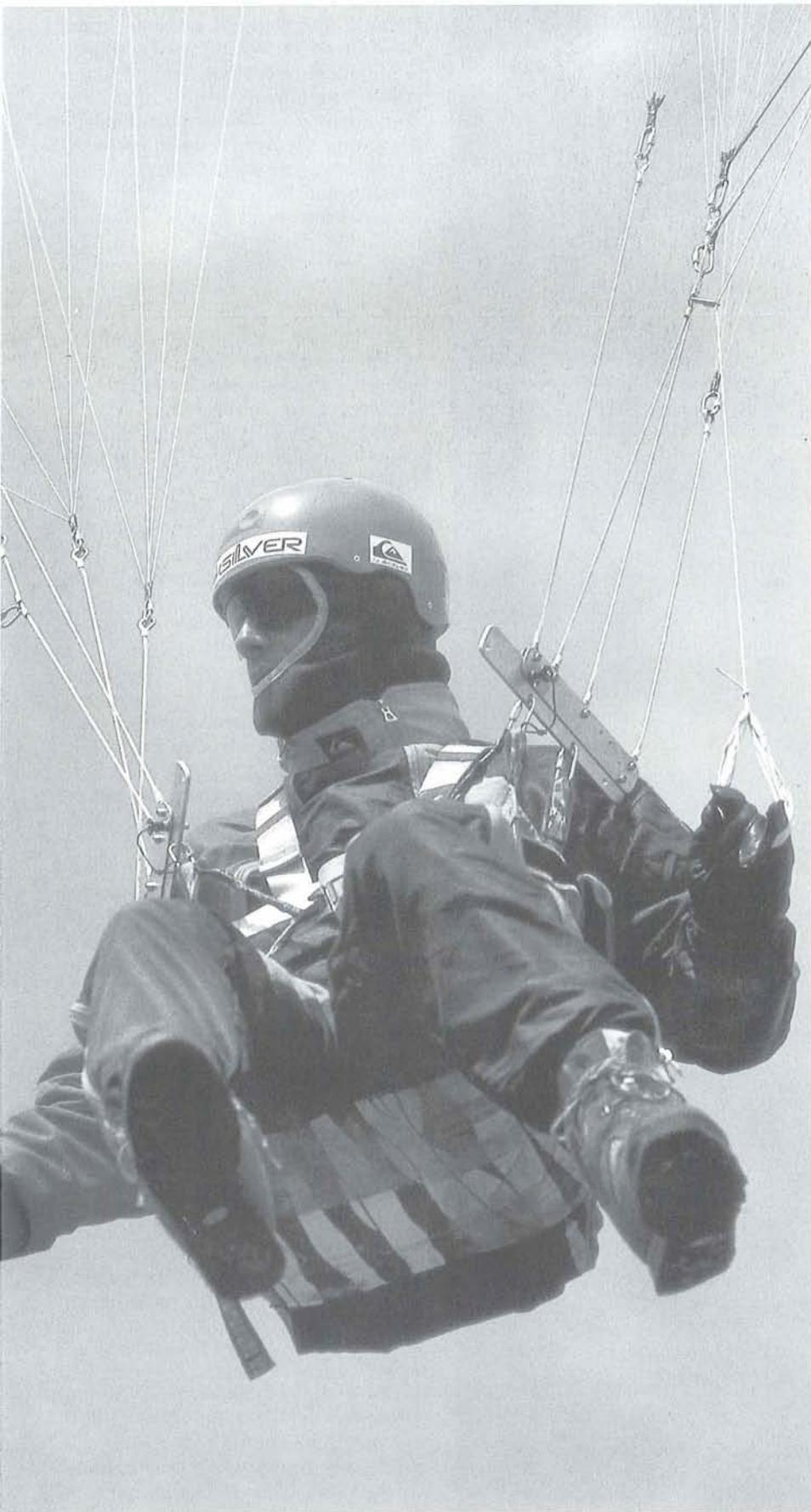
möglichkeit des Piloten über seine Sitzstellung auf den Anstellwinkel des Gerätes durch ein sogenanntes Steuersitzbrett und die strömungstechnische Verbesserung des Widerstandskörpers »Pilot« durch flachere Sitzstellung und Verkleidungen, insbesondere der Beine, in einem geschlossenen Liegegurt (Abb. 3 und 4)
