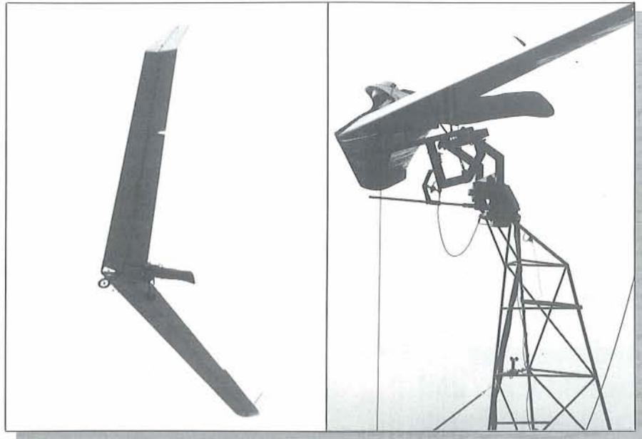
Flair 30 von Prof. Günther Rochelt in Erprobung. Das rechte Bild zeigt den Flair 30 auf dem Testwagen. Wegen der Pilotenposition auf dem Flügel konnte erstmalig eine Pilotenatruppe direkt in die Meßfahrt einbezogen werden. Auf dem linken Bild führt Knut von Hentig einen Flugversuch durch. Die bisherigen Testergebnisse zeigen eine etwa verdoppelte Flugleistung.
