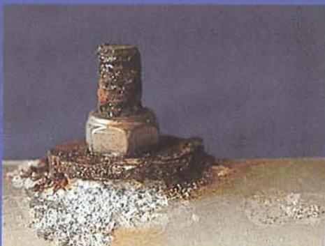
Cadmierte Schraube mit Mutter, neu und nach 23 Wochen Prüfkammer
