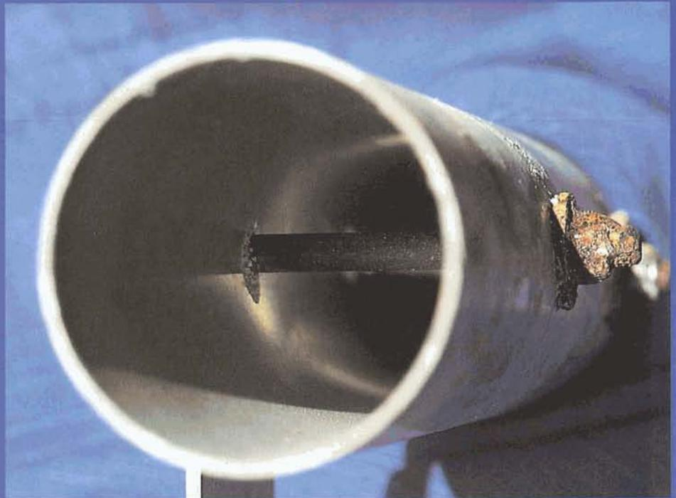
Besonders heimtückisch: An der Durchführungsstelle der Schraube beginnt auch im Innenbereich des Rohres die Korrosion
