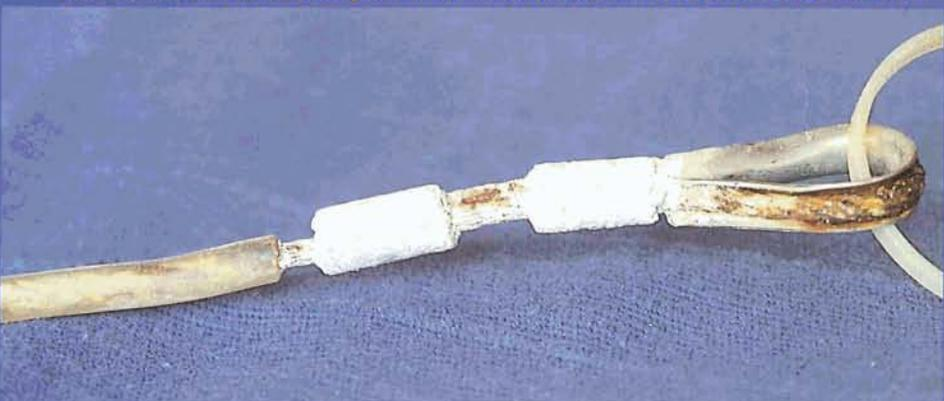
Dicke Deckschicht über den Pressnippeln, im Kauschenbereich ist das Seil bereits angefressen
