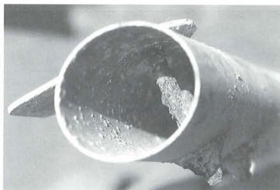
Bei einem Korrosionstest in den Prüfkammern der Audi AG wurden Alurohre mit Beschlagteilen sowie Verspannungsseile mit und ohne Kunststoffummantelung untersucht. Wichtige Erkenntnis: Auch VA-Seile können Rosten
