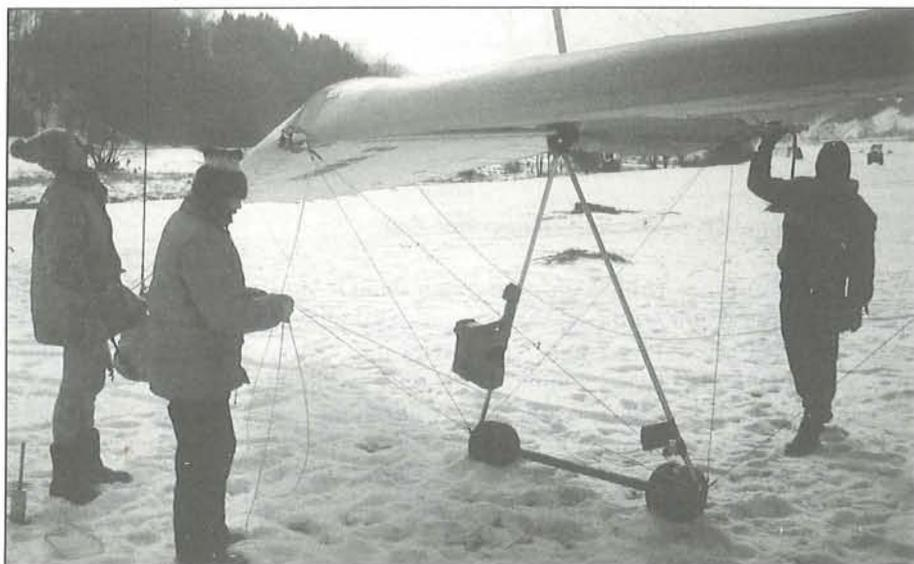
Abb. 21: Die am Steuerbügel montierte Filmkamera mit Blick auf Beschleunigungsmesser und Digitaluhr
