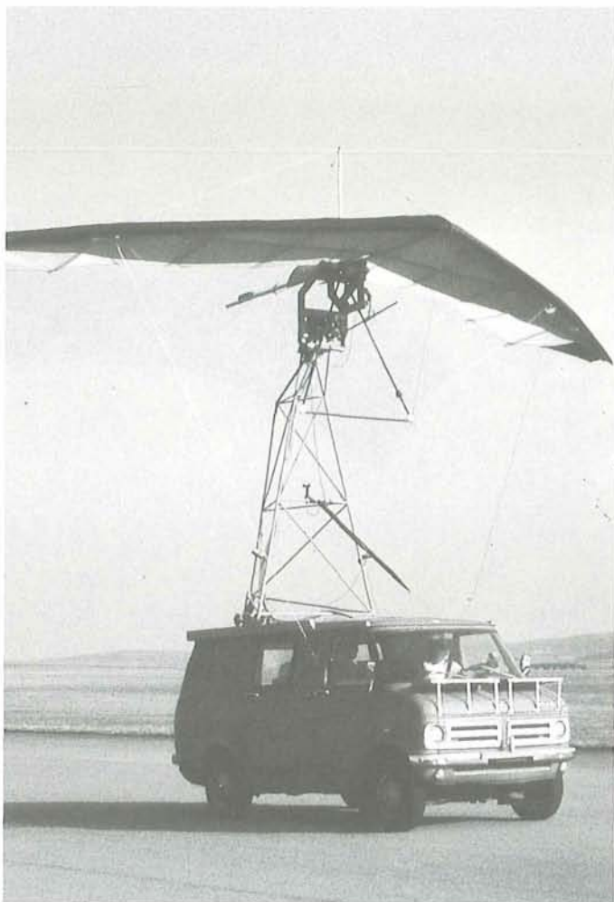
Zuverlässiger Bedford-Meßwagen 1982–1986. Neuer Meßkopf und Eichflügel erlauben große Genauigkeit (Abb. 6).
