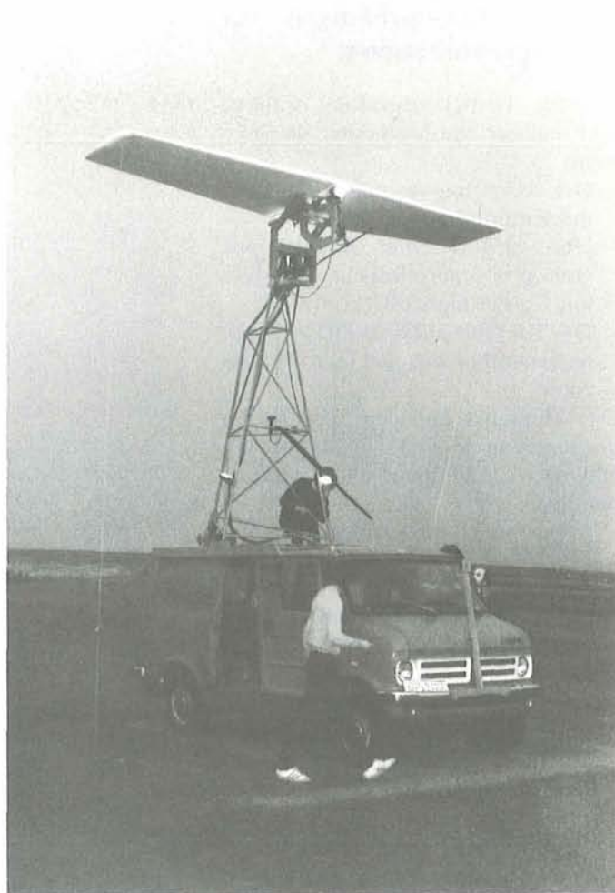
Zuverlässiger Bedford-Meßwagen 1982–1986. Neuer Meßkopf und Eichflügel erlauben große Genauigkeit (Abb. 6).
