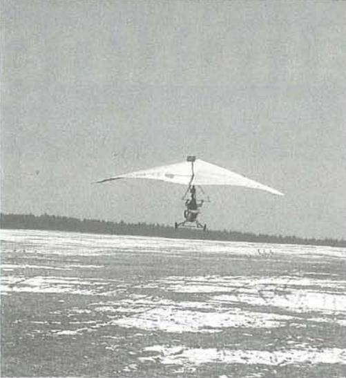
Bei der Landung hat der Pilot die Aufgabe, den Drachen in der Luft so abzubremsen, daß die Geschwindigkeit über Grund bei Bodenkontakt nahe oder gleich Null ist. Aufgrund der heutigen Hochleistungsgeräte mit großer Geschwindigkeitsspanne ist es wichtig, bereits bei Flügen mit Schulungsgeräten eine effektive Landetechnik zu erlernen bzw. zu lehren.
