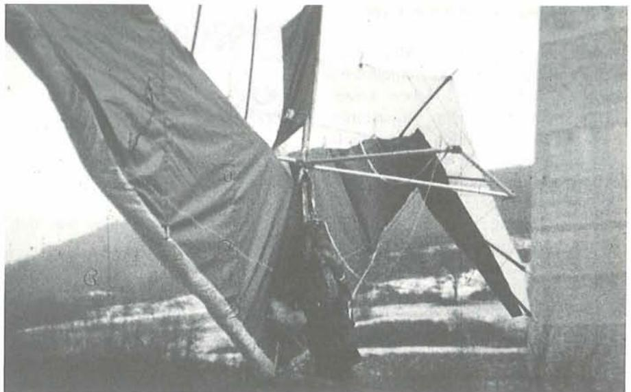
Die Versuchsanordnung: Drachen senkrecht nach unten aufgehängt. 100-kp-Puppe freischwingend am Pilotenaufhängepunkt befestigt, dort auch befestigt die Endschlaufe der Fallschirmverbindungsleine. Der Fallschirmcontainer mit lose aufliegender Verbindungsleine neben der Puppe hängend und von einer Hilfschnur am Auslösemechanismus des Hängegleiters befestigt. Bei Auslösung des Hängegleiters wird zugleich auch der Schirmcontainer freigegeben.
