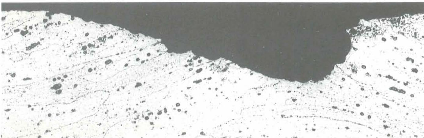
Längsschliff (geätzt) durch eine Kerbe, Tiefe der Kerbe ca. 0,085 mm. 200fach vergrößert.
