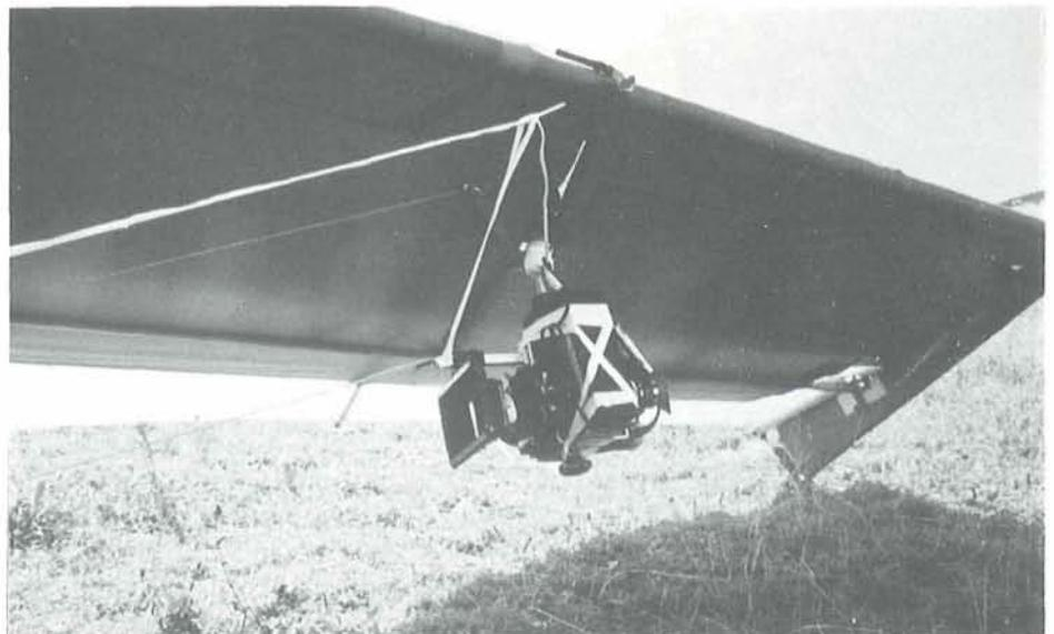
*Nur etwas für routinierte Flieger: 16 mm Arriflex an der Querstrebe eines Fledgelings. Mit Akkus und Gegengewicht sind das runde 15 kg zusätzliches Gewicht*
