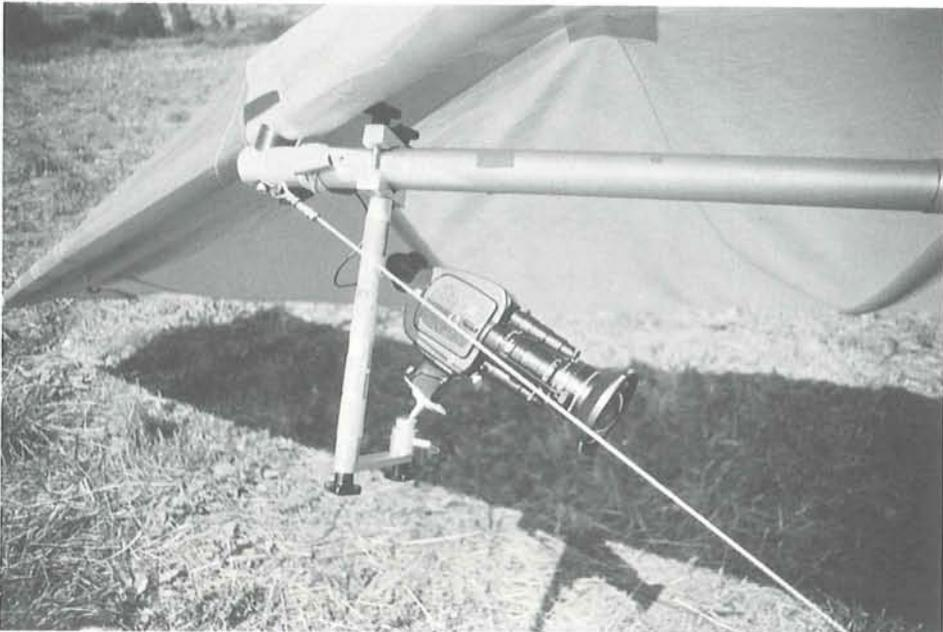
Montage einer Super-8-Kamera am Querrohr. Unbedingt für Ausgleichsgewicht sorgen!
