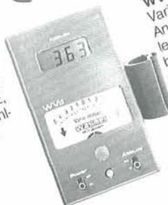
**WVd:** Das Kombi-Instrument! Variometer mit innenliegender analoger Anzeige, Höhenmesser mit sehr gut ablesbarer Flüssigkristall-Anzeige. Meßbereich 7000 m, akkustischer Signalton proportional zur Steiggeschwindigkeit, Power 9V-Batt.
