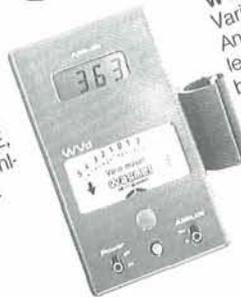
**WVd:** Das Kombi-Instrument! Variometer mit innenliegender analoger Anzeige, Höhenmesser mit sehr gut ablesbarer Flüssigkristall-Anzeige. Meßbereich 7000 m, akustischer Signalton proportional zur Steiggeschwindigkeit, Power 9V-Batt.
