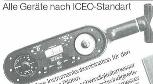
**WVC:** Eine Instrumentenkombination für den anspruchsvollen Piloten. Variometer und Geschwindigkeitsmesser 60 mm Rundinstrument. Geschwindigkeits-sensor im Gehäuse integriert. Höhenmesser bis 7000 m, einstellbar nach QNH und QFE, beim Flug einzeln abrufbar. Halterung wahlweise für alle Trapezrohre. Power 9V-Batt.
