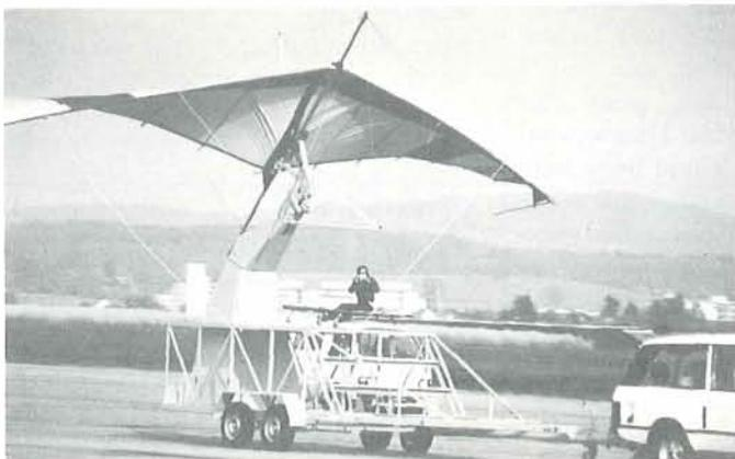
*Abb. 12: Gryphon-Flügel unter höchster Last*
