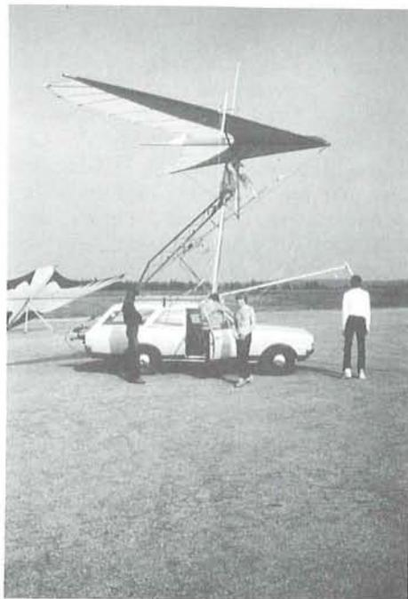
Abb. 5: Der erste vollwertige Flugmechanik-Meßwagen im Sommer 1978
