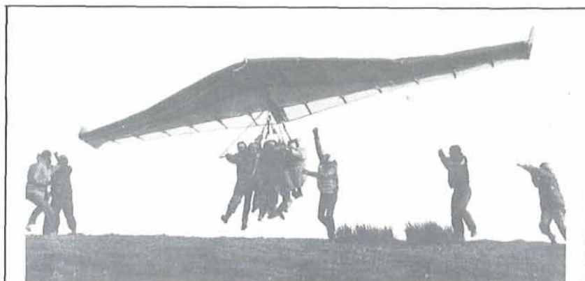
6 g Test einmal anders. Die englische Firma Hiway belastet ihren „Explorer“. Wer von den Piloten lenkt oder ob sich die Piloten auf gemeinsame Lenkausschläge durch Mehrheitsentscheidung einigen konnten ist nicht bekannt.
