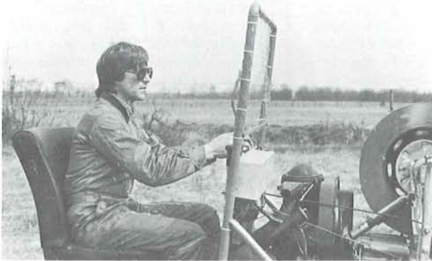
Schlepperprobung mit der Großklaus-Winde.
