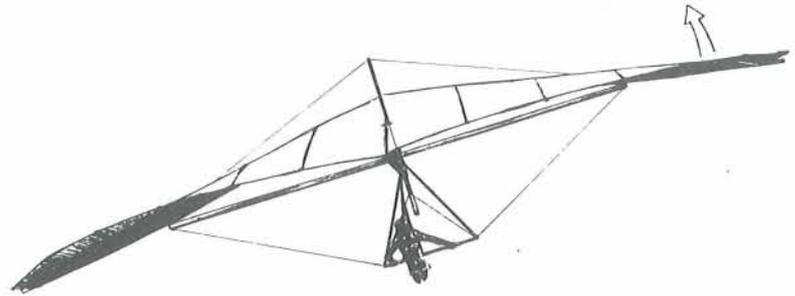
**Klaus:** Ist also wichtig, daß in einer Linkskurve die linke Flügelseite weniger Auftrieb produziert, als die Flügelaussenseite rechts, weil ein höherer Tunnel links den Auftrieb mindert, bzw. ein flacher Tunnel rechts eine gute Auftriebserzeugung bewirkt?
