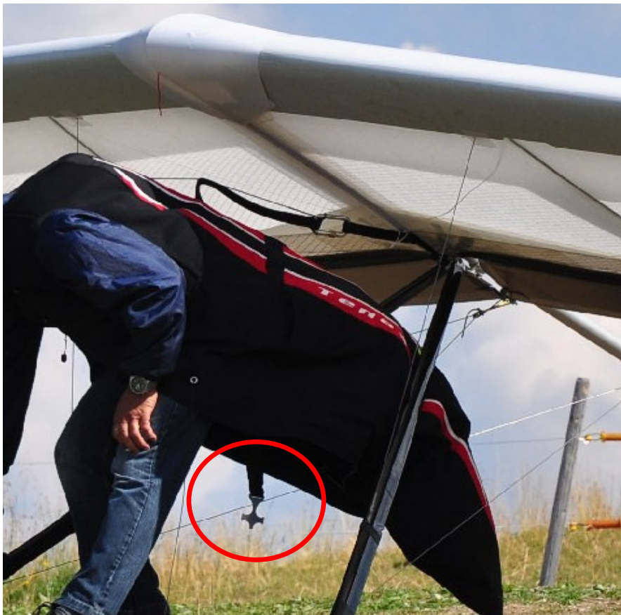
Bild 1: Der Pilot hat seine Startvorbereitungen beendet. Im Moment der Aufnahme schaltet er gerade sein Vario/GPS ein. Deutlich sichtbar (im Kreis), das T-Stück der Beingurteverschlüsse. Beide Beingurte sind unverschlossen.
