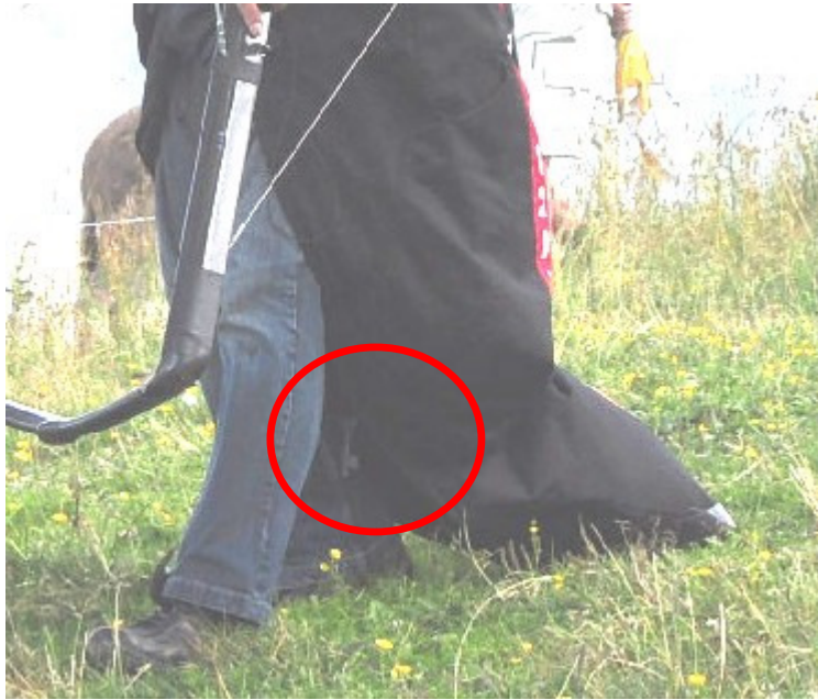
Bild 2: Der Pilot unmittelbar vor dem Start. Im Bild deutlich ersichtlich: Beide Beingurte sind offen, das zum Verschließen notwendige T-Stück hängt frei herunter (im Kreis).
