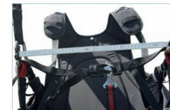
**Brustgurteinstellung: Links maximal weit geschlossener Brustgurt (35cm), Mitte maximal weit offener Brustgurt (55 cm), rechts eine moderate Einstellung (43 cm), wie sie von vielen Herstellern empfohlen wird.**
