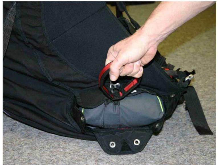
*Empfehlenswert: Nach dem Öffnen der Splinte ist der Innencontainer frei und kann sofort weggeschleudert werden.*
