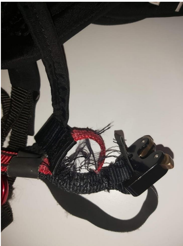
Abbildung 1: Die gebrochene Haupt-Aufhängung
