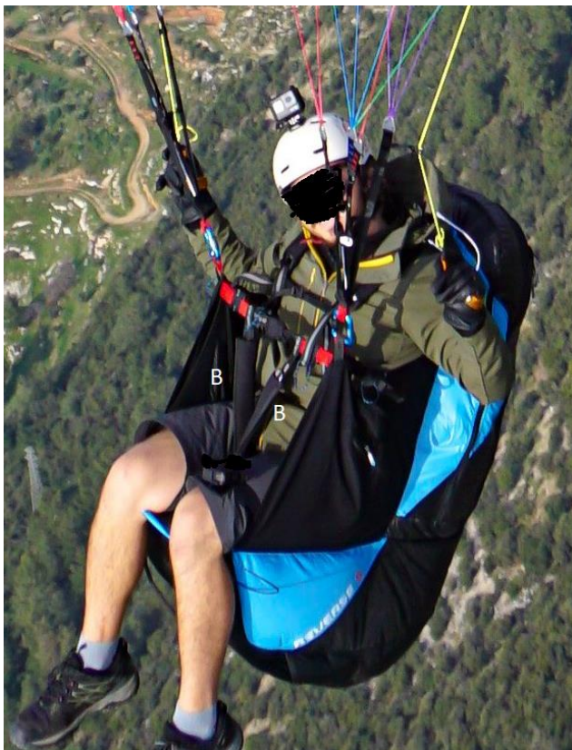
Abbildung 2: Das Getup-Gurtsystem des Sky Paragliders Reverse 5 Gurtzeugs. Mit B gekennzeichnet die beiden Beingurte, die zum Frontgurt (Brustgurt) führen. Bei dem Unfall war nur der in Flugrichtung linke (im Bild rechte) Beingurt mit dem Frontgurt (Brustgurt) verbunden. (Bild: Website Sky Paragliders)
