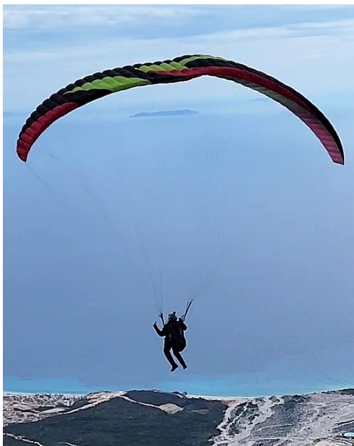
Abbildung 1: Durch die offenen Gurte der rechten Seite zieht es den rechten Tragegurt nach oben, dadurch entsteht der Knick in der Kappe. Die hängende Position des Piloten ist gut zu erkennen.
