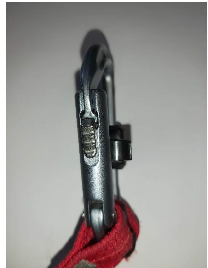
Bild 3: Der nicht verriegelte Kunststoff-Steg (schwarz) von vorne.
