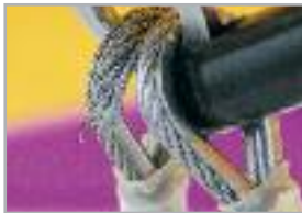
Kauschen und Seile müssen auf Beschädigungen überprüft werden und in diesem Fall ausgetauscht werden.
