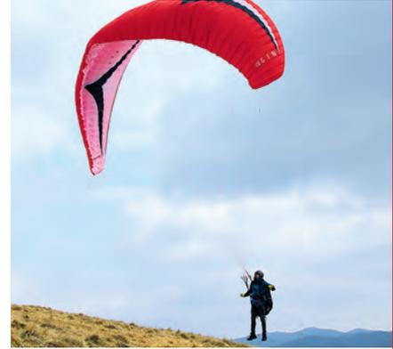
Der Pilot zieht den Schirm deutlich über die A-Leinen auf und versucht den Schirm schnell aus der Powerzone über sich zu bringen. Der Pilot geht der Kappe bei etwa 70° mit schnellen Laufschritten entgegen und löst schlagartig die A-Leinen. Die Kappe erreicht die größte Kappengeschwindigkeit im letzten Drittel der Aufziehphase und wird durch einen Vollausschlag der Steuerleinen gestoppt.
