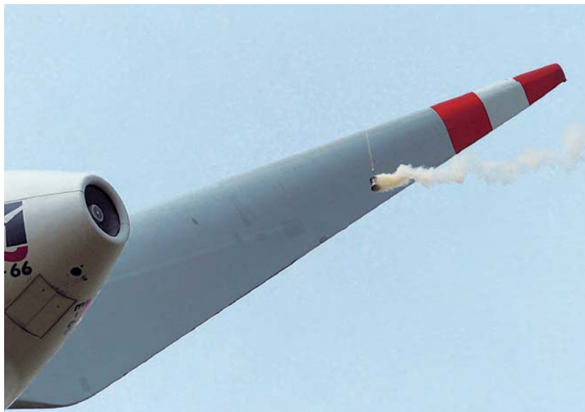
Die Rauchkörper wurden mit einer 10 m langen Leine an einem Multicopter befestigt und im Lee der Windkraftanlage platziert.
