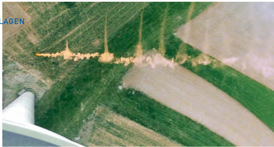
Blick vom Geschiebekopf des WKA nach unten mit dem positionierten Rauchkörper. Dahinter die abschwimmenden Wirbel.
