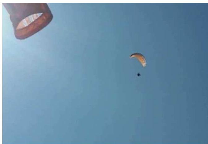
Abbildung 8: ...und es kommt an der Kurveninnenseite (in Flugrichtung rechts) zum beginnenden einseitigen Strömungsabriss.
