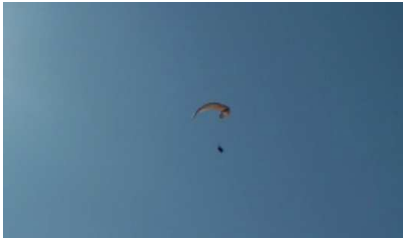
Abbildung 13: Die eingeklappte Flügelhälfte öffnet sich nur teilweise wieder, ein Teil des Außenflügels hat sich in den Leinen des Gleitschirms verhängen. Durch die heftige, asymmetrische Schleuderbewegung des Vorschießens der Kappe, haben sich Pilot und Passagierin um die Hochachse in die Tragegurte eingedreht (Twist). Dadurch ist die Steuerung des Gleitschirms blockiert
