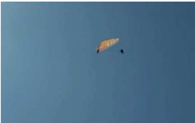
Abbildung 10: ...die durch aktives unten Halten der rechten Steuerleine vom Piloten über eine ca. 270°-Drehung gehalten wird. In einer sehr ungünstigen Drehphase, die Kappe asymmetrisch hinter Pilot/Passagierin, gibt der Pilot die heruntergezogene rechte Steuerleine nach oben frei... 4
