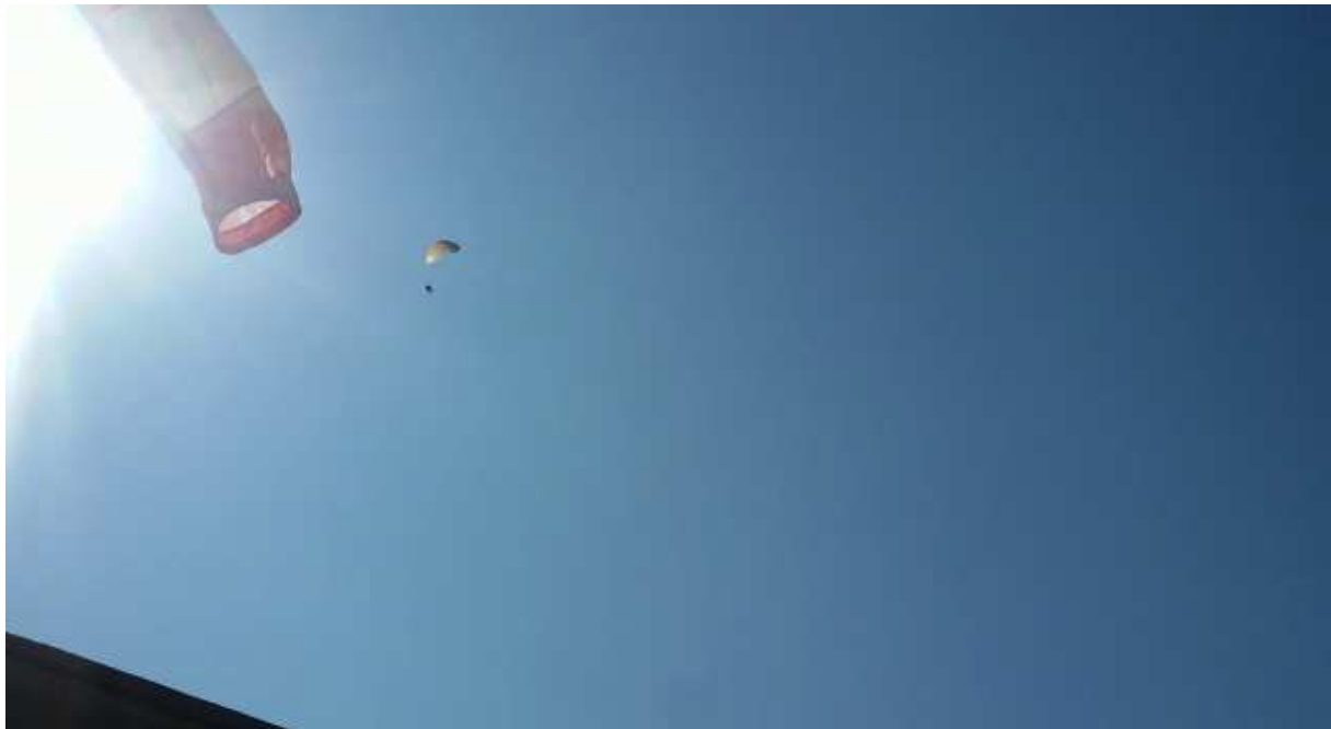
Abbildung 1: Ein Standbild aus dem Video, das den Unfallablauf zeigt, unmittelbar vor Beginn des Absturzes: Der Doppelsitzer fliegt mit ca. 100-120 m GND in nordwestlicher Richtung, der Windsack zeigt leichten Ostwind.
