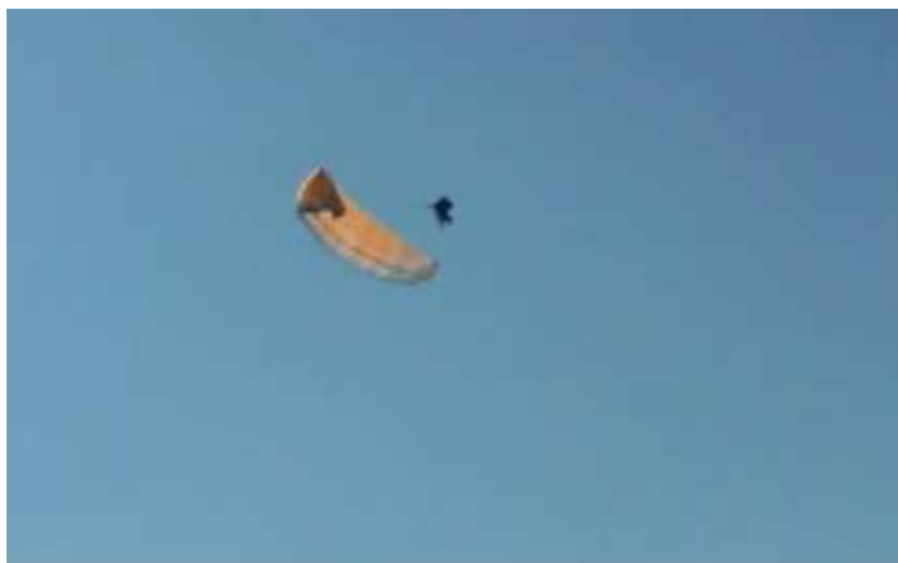
Abbildung 14: Durch den einseitigen großen Widerstand des verhängten Außenflügels gerät der Gleitschirm in einen schnellen Spiralsturz nach links. Bei einem Doppelsitzer-Gleitschirm
