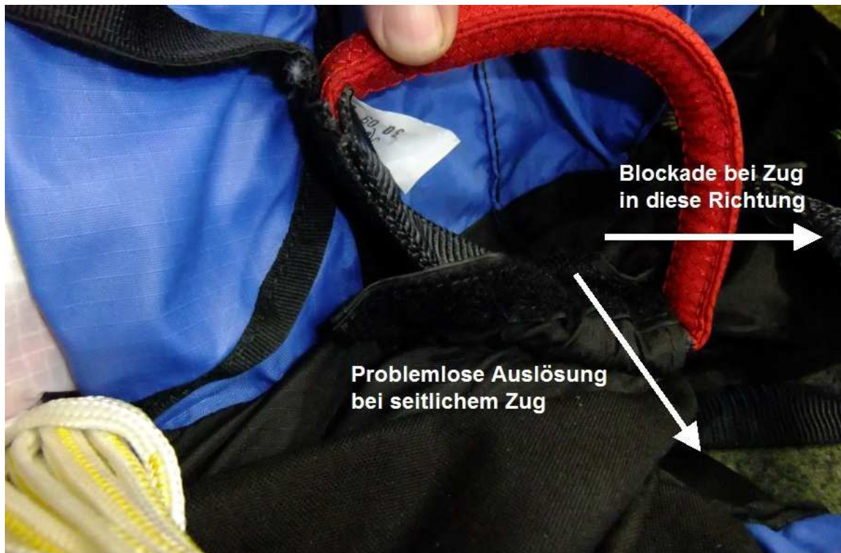
Abbildung 4: Bei Zugrichtung nach vorne löste sich der hintere Teil des Kletts ab, der vordere Teil schob sich ziehharmonikaförmig zusammen und blockierte ein weiteres Öffnen. Die Blockade trat nur ein, wenn die Zugrichtung nach vorne beibehalten wurde. Wechselte die Zugrichtung nach eingetretener Blockade auf seitlich, konnte der Griff aus dem Klett gelöst werden. Keine Probleme, den Griff aus seiner Klett-Umhüllung abzuziehen und das Rettungsgerät auszulösen, gab es, wenn von Beginn an der Griff seitlich vom Klett abgezogen wurde.
