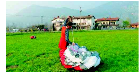
Schritt 2| Den Schirm als Tulpe zum ausgelegten Schlauchpacksack tragen, dabei weiter auf gestreckte Leinen achten.
