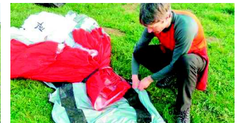
Schritt 6| Tragegurte in der Tasche am Schlauchpacksack verstauen.
