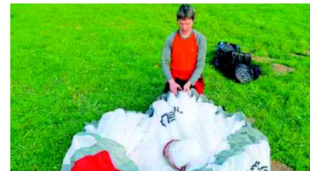
Schritt 7| Eintrittskante Zelle auf Zelle sortieren. Die Leinen liegen weiter geordnet um die Stoffnase im Untersegel.
