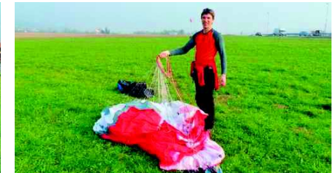
Schritt 4| Die Tragegurte an der Hinterkante ablegen. Ausreichend Leinenlänge vom Kringle wieder abwickeln, um bis zur Schirmmitte gehen zu können.
