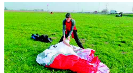
Schritt 5| Eine Stoffnase aus dem Untersegel lupfen, den Leinenkringle darüber legen und durch Umknicken der Stoffnase fixieren.
