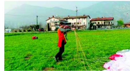
Schritt 1| Der ausgebreitete Schirm wird mit gestreckten Leinen zur Tulpe gerafft. Dabei dem Schirm entgegen gehen, nicht über den Boden ziehen.
